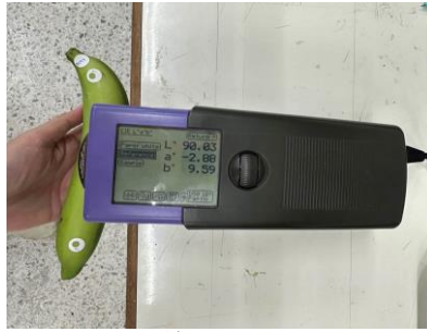
ภาพที่ 3.15 เครื่องวัดสีของเปลือกกล้วย
