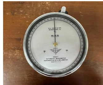
ภาพที่ 3.4 เครื่องทดสอบความหนาของกระดาษ
