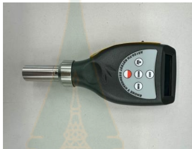
ภาพที่ 3.16 เครื่องวัดความแน่นเนื้อของกล้วย
