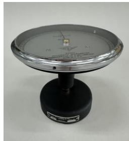
ภาพที่ 3.4 เครื่องทดสอบความหนาของกระดาษ
